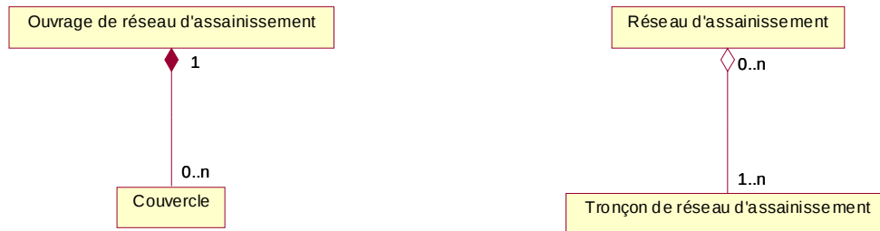
Figure 122. A gauche, relation de composition, et à droite, relation d'agrégation "faible".
