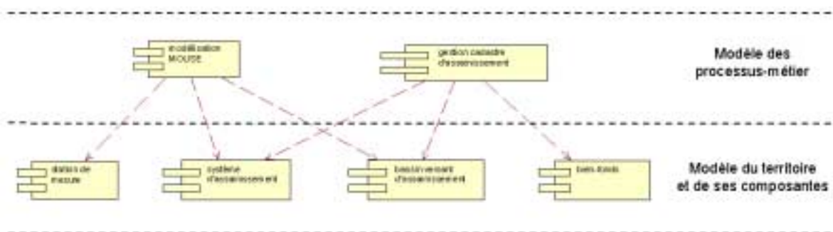
Figure 42. Les composants-processus (modélisation MOUSE, gestion cadastre d'assainissement) s'appuient sur les composants-entité.
