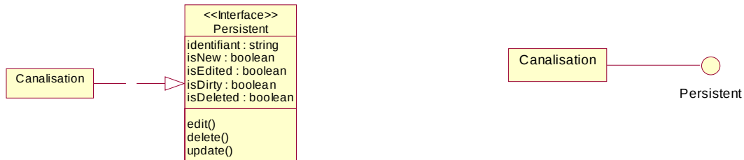
Figure 125. L'interface "Persistent", qui définit les opérations nécessaires à la gestion de la persistance des objets, est réalisée par la classe Canalisation.
