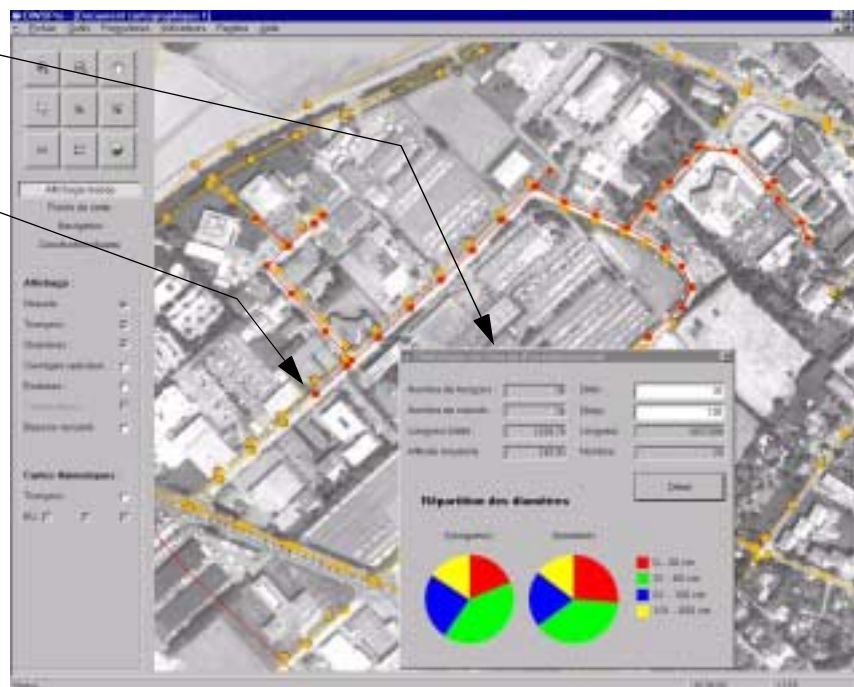
Figure 114. Calcul de la répartition des diamètres dans le réseau de canalisations sélectionné (en rouge). Les possibilités de navigation dans le réseau sont par ailleurs visibles sur la palette à gauche.
