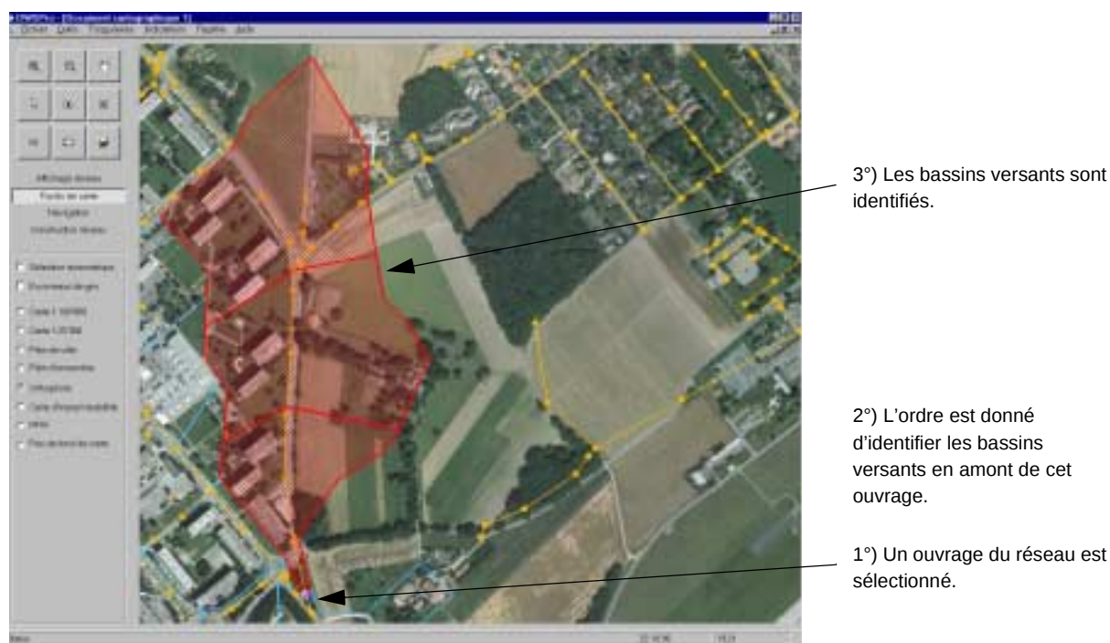
Figure 111. Détermination automatique de bassins versants d'assainissement.
